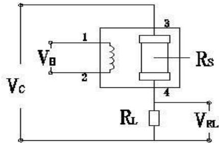
图 2: MP-4 测试电路
